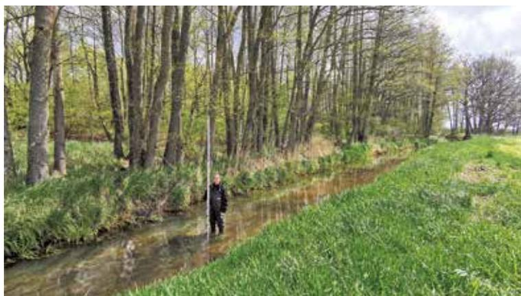
*Für die Darstellung des Gewässerquerschnitts der Ohre wurde das Höhenprofil ermittelt.*
